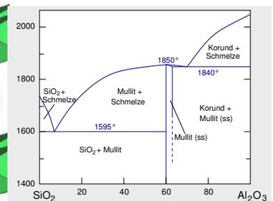
Phasendiagramm  $\text{SiO}_2 - \text{Al}_2\text{O}_3$
