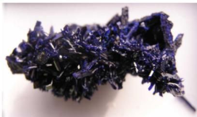
▶  $\text{Cu}_3(\text{OH})_2(\text{CO}_3)_2$  (basisches Kupfercarbonat)
